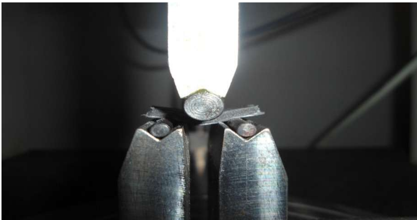
Corpo de prova do material CF/PA6 durante ensaio de cisalhamento interlaminar
